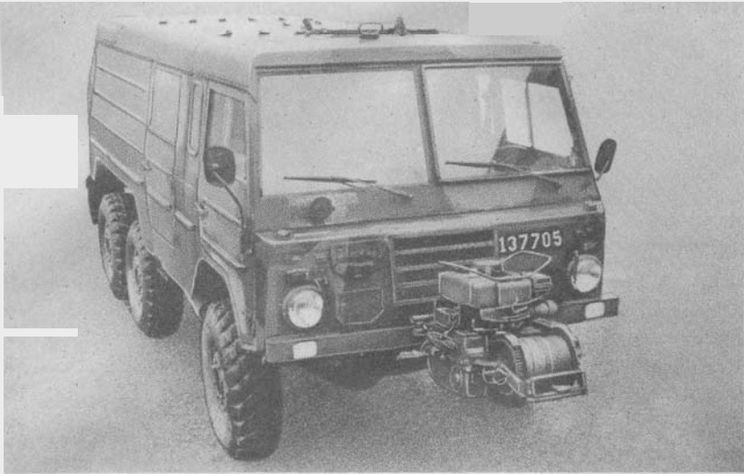
Bild 1. Bärningsvinsch på terrängbil 13
