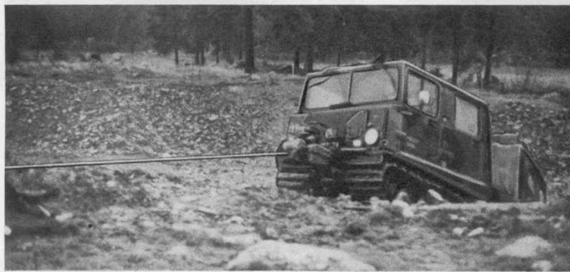
Bild 36. Bärgning av bandvagn 202
