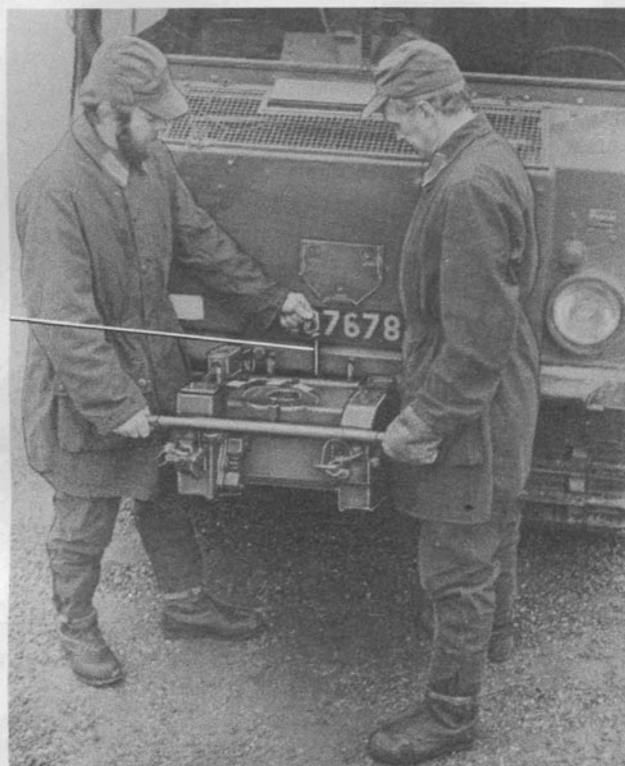
Bild 24. Ditsättning av vinschväxelhuset
