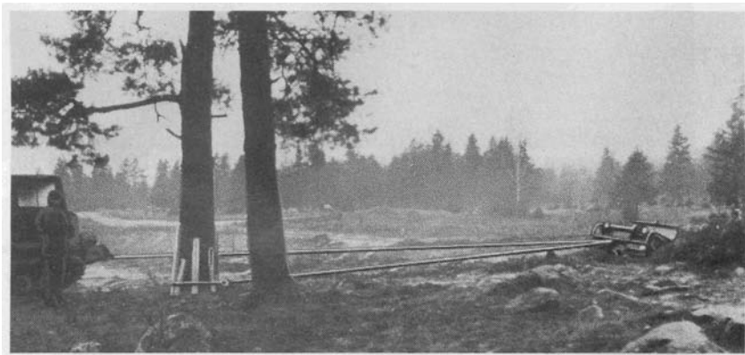
Bild 34. Bärgning av bandvagn 202
